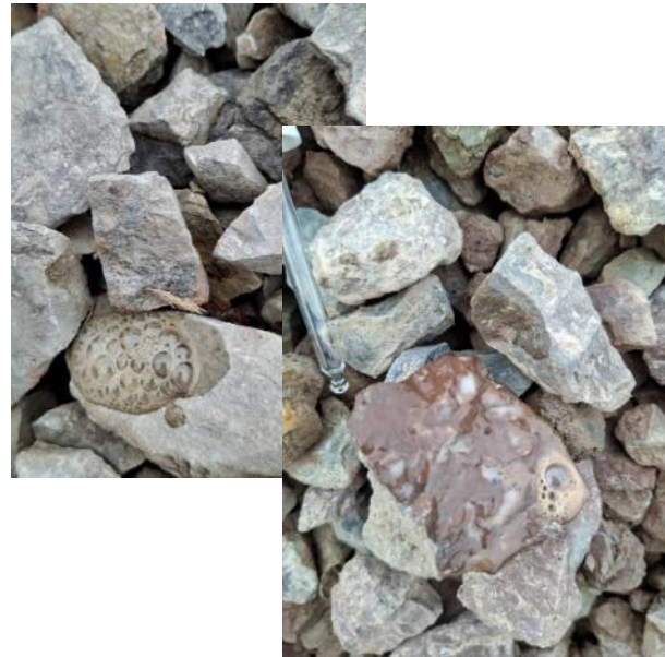
Starke Reaktion nach Zugabe von 10%iger HCL: Hinweis auf hohe \text{CaCO}_3 - und Basengehalte
