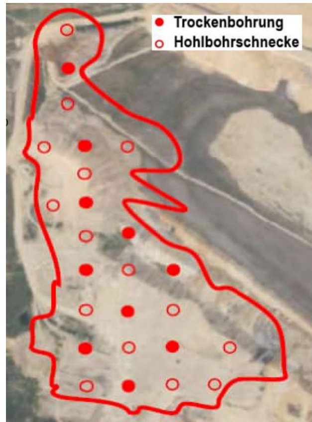
Bild 6.1 – Geplante Aufschlusspunkte auf dem Verwertungsbereich Jüchen alt (Quelle: Geotechnisches Büro Prof. Dr.-Ing. H. Düllmann GmbH vom 20.02.2025)
