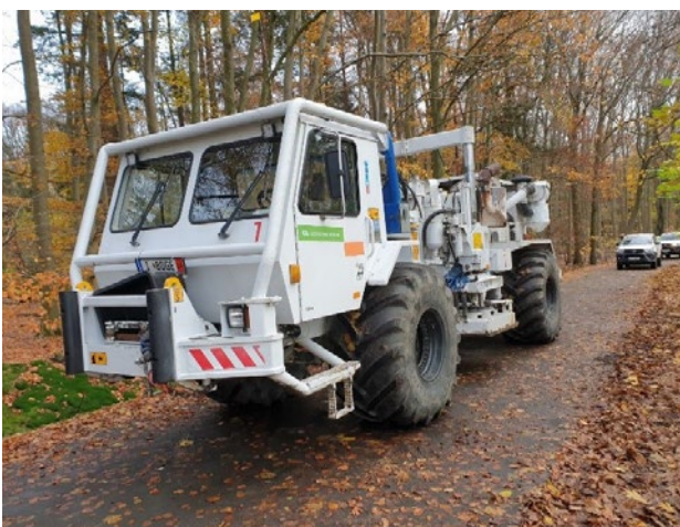
Bild 8.2 – Vibrotruck Type IVI Birdwagon Mark 4b mit HEMI 50 Vibrator (Quelle: geophysics & more)
