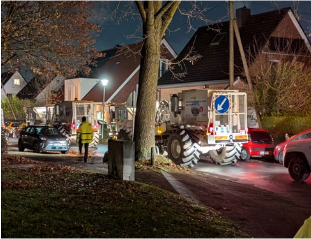
Bild 1.2 – Messungen mittels Vibro-Trucks im Stadtgebiet Münster (Quelle: Bezirksregierung Arnsberg)
