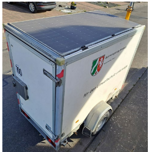
Bild 5.1 – Mobile Lärmmessstation mit neu installierter PV-Anlage (Quelle: Bezirksregierung Arnsberg)
