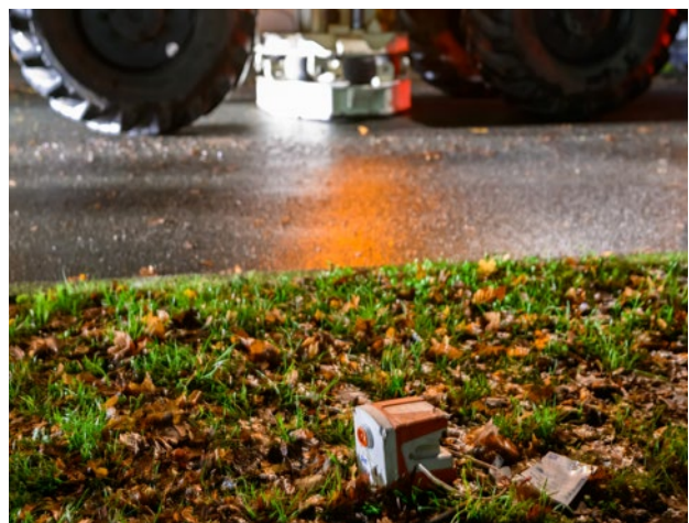
Bilder 11.2 – Vordergrund: Geophon im Feld, Hintergrund: vibroseismische Anregung (Quelle: Stadtwerke Münster, Michael C. Möller)
