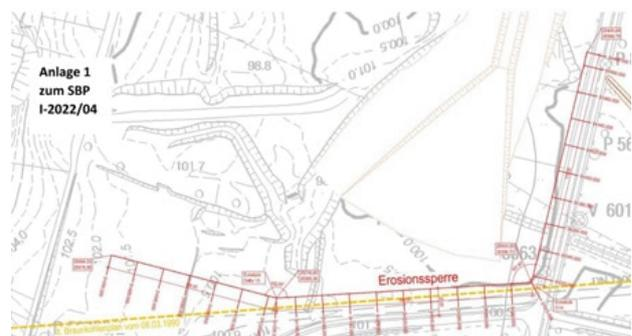
**Bild 3.7** – Verlauf Spundwand (Quelle: Auszug Sonderbetriebsplan RWE Power AG)
