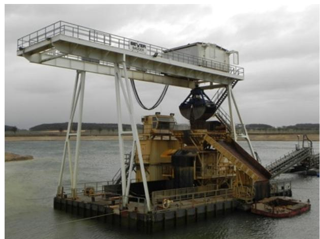
**Bild 8.2** – Schwimmgreiferanlage (Quelle: Bezirksregierung Arnsberg)
