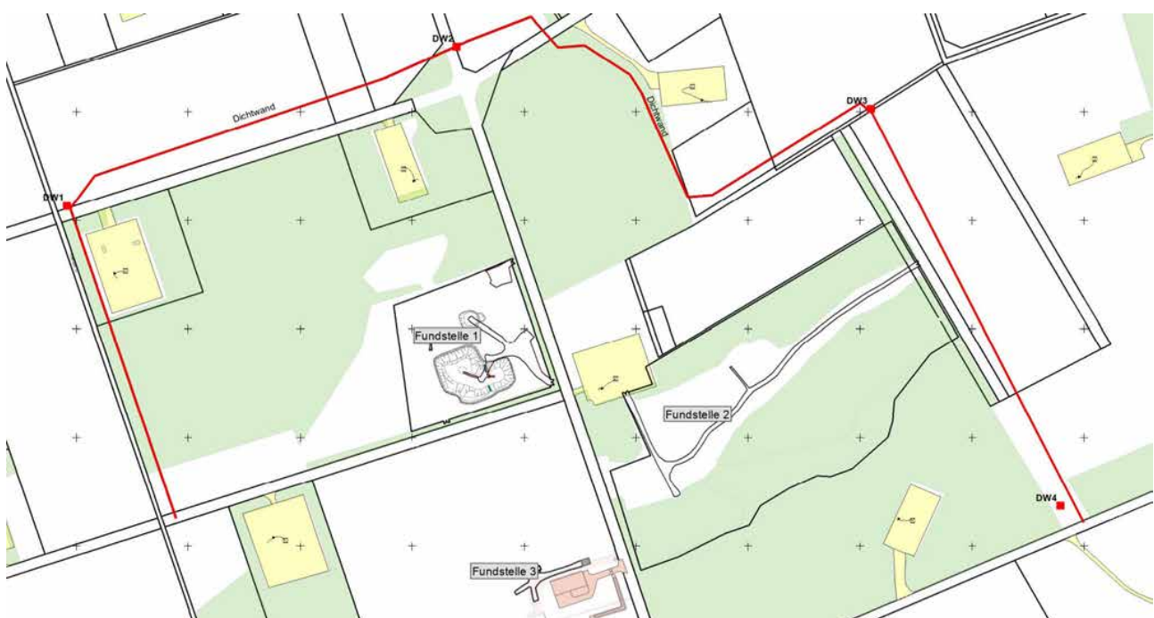
Bild 12.5 – Verlauf der Dichtwand (Rot) (Quelle: Salzgewinnungsgesellschaft Westfalen mbH)
