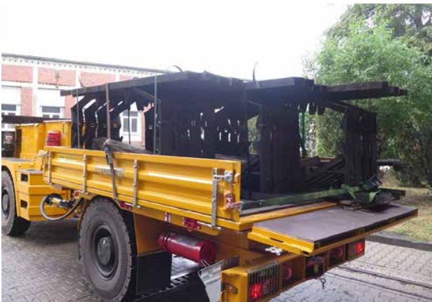
Bild 9.6 – Servicefahrzeug mit Bandkonstruktion beladen
