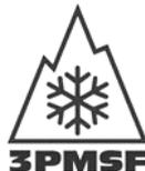
Die Nutzung von M+S Reifen als Winterreifen ist grundsätzlich nicht mehr zulässig. Reifen, die sowohl über eine M+S-Kennzeichnung als auch über das Alpine-Symbol verfügen, erfüllen die Anforderungen des [§ 36 Absatz 4 StVZO](#).
