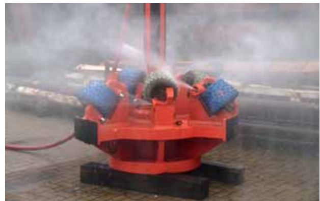
Bild 11.4 – Erweiterungsbohrkopf mit Zusatzbedüsung
