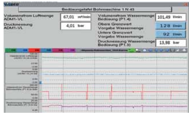
Bild 11.7 – Aufzeichnung der Bedüsungs- und Bewetterungsparameter
