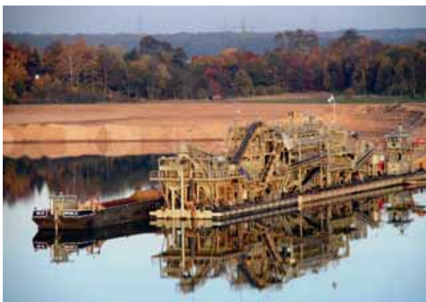
Bild 7.1 – Eimerkettenschwimmbagger im Tagebau Lippe
