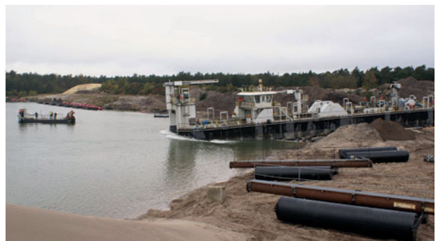
Bild 6.4 – Zuwasserlassung des Baggerschiffes im Tagebau Haltern-Sythen (Quelle: Quarzwerke GmbH)
