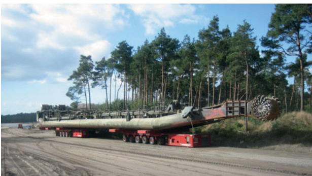
Bild 6.3 – Bagger auf Scheuerle-Schwerlast-transportsystemen (Quelle: Quarzwerke GmbH)
