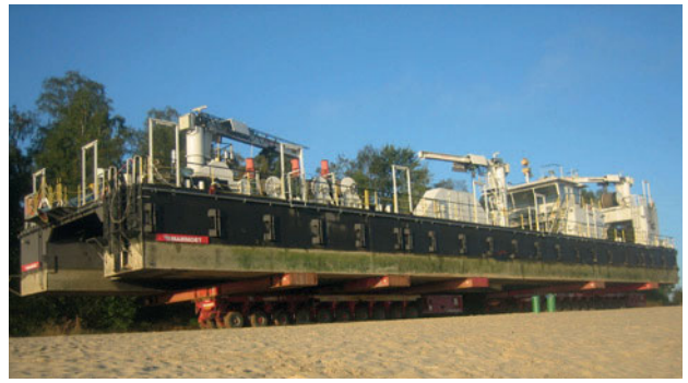
Bild 6.2 – Bagger auf Scheuerle-Schwerlast-transportsystemen (Quelle: Quarzwerke GmbH)
